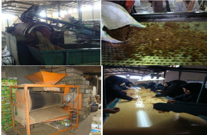
B - دستگاه‌های جداسازی خوشه‌ها و مواد همراه و شستشوی کشمش، جدا نمودن کشمش‌های معیوب و آسیب دیده روی ریل در کارخانه و دستگاه حذف دم کشمش
