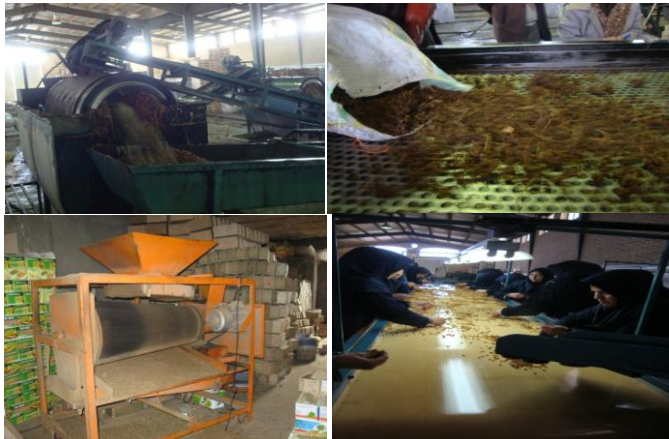
B - دستگاه‌های جداسازی خوشه‌ها و مواد همراه و شستشوی کشمش، جدا نمودن کشمش‌های معیوب و آسیب دیده روی ریل در کارخانه و دستگاه حذف دم کشمش
